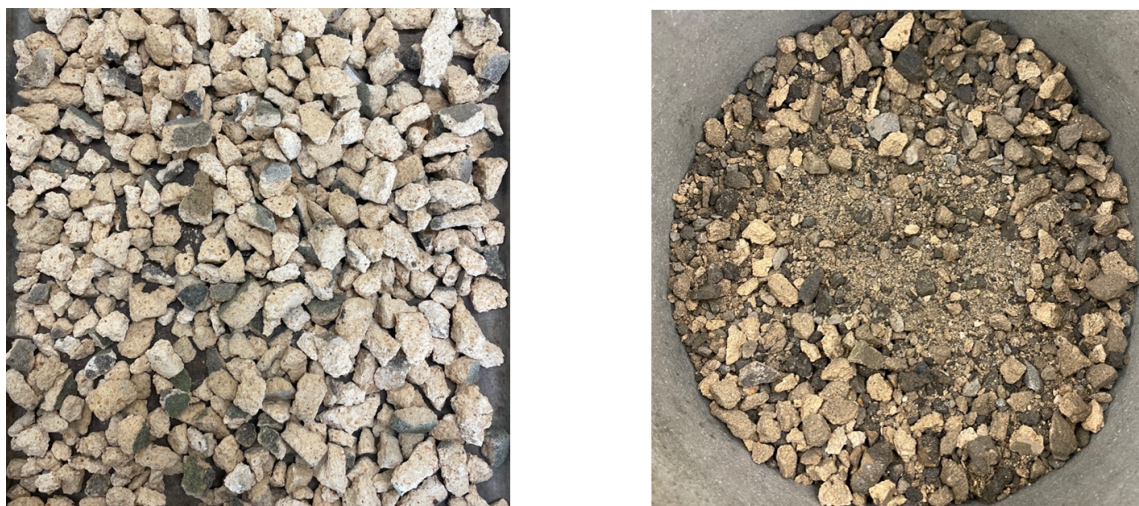
Рис. 2. Вид материала на основе боя кирпичной кладки из стенового материала здания (слева) и вид смеси минерального материала для составов № 2 и № 3 (справа)
